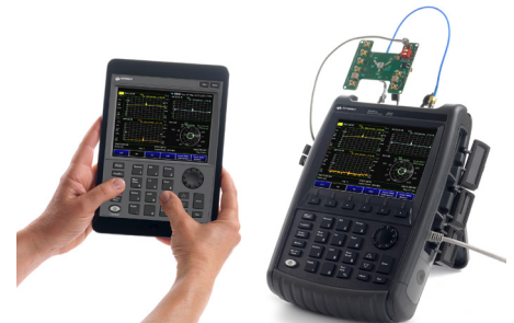
Просмотр результатов измерений и управление FieldFox через iPad
